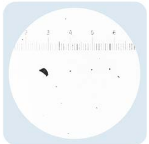
ISO 4406 Classe 17/15/12 SAE AS4059 Tableau 1 Classe 6 NAS 1638 Classe 6 SAE AS4059 Tableau 2 Classe 7A/6B/6C
